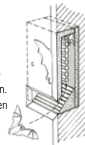
▲ Schnitt: 1FE mit Rückwand
